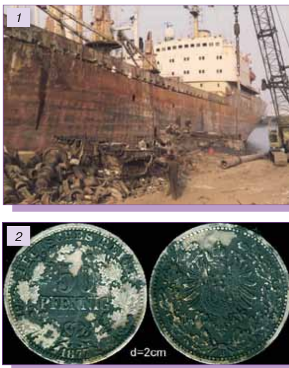
Мал. 4.18. 1. Іржа їсть залізо: кладовище кораблів у Бангладеш. 2. Корозія срібного сплаву
