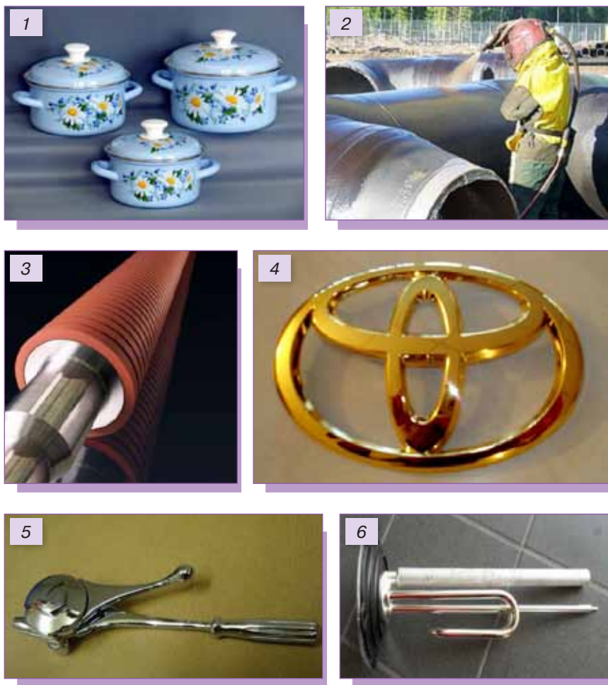
Мал. 4.19. Способи запобігання корозії. 1. Емалювання. 2. Фарбування. 3. Гумування. 4. Золотіння. 5. Нікелювання. 6. У бойлері магнісвий анод приймає удар корозії на себе
