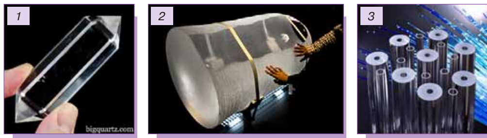
Мал. 4.3. 1. Природний кристал кварцу. 2. Вирощений у штучних умовах монокристал кварцу високого ступеня чистоти. 3. Волоконна оптика — одна з найсучасніших і високотехнологічних галузей промисловості
