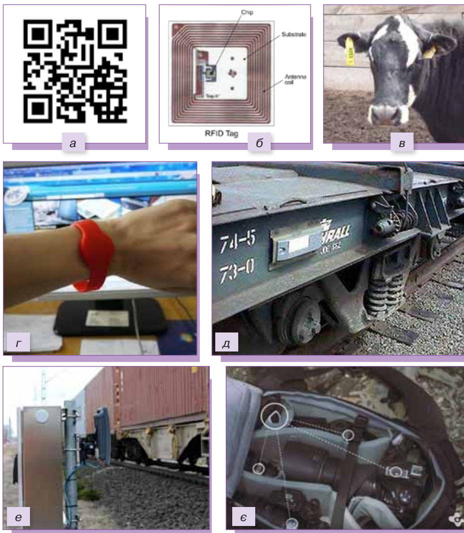
Мал. 8.22. а) QR-код; б) RFID-мітка; в) використання RFID-міток для ідентифікації тварин, г) браслетів для басейнів, д) на залізничних вагонах для автоматизації реєстрування руху вагонів за контрольними точками, е) для автоматизації зважування, є) пошуку речей
